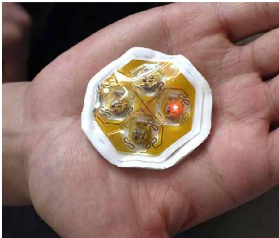
Parte inferior del dispositivo de retroalimentación háptica
