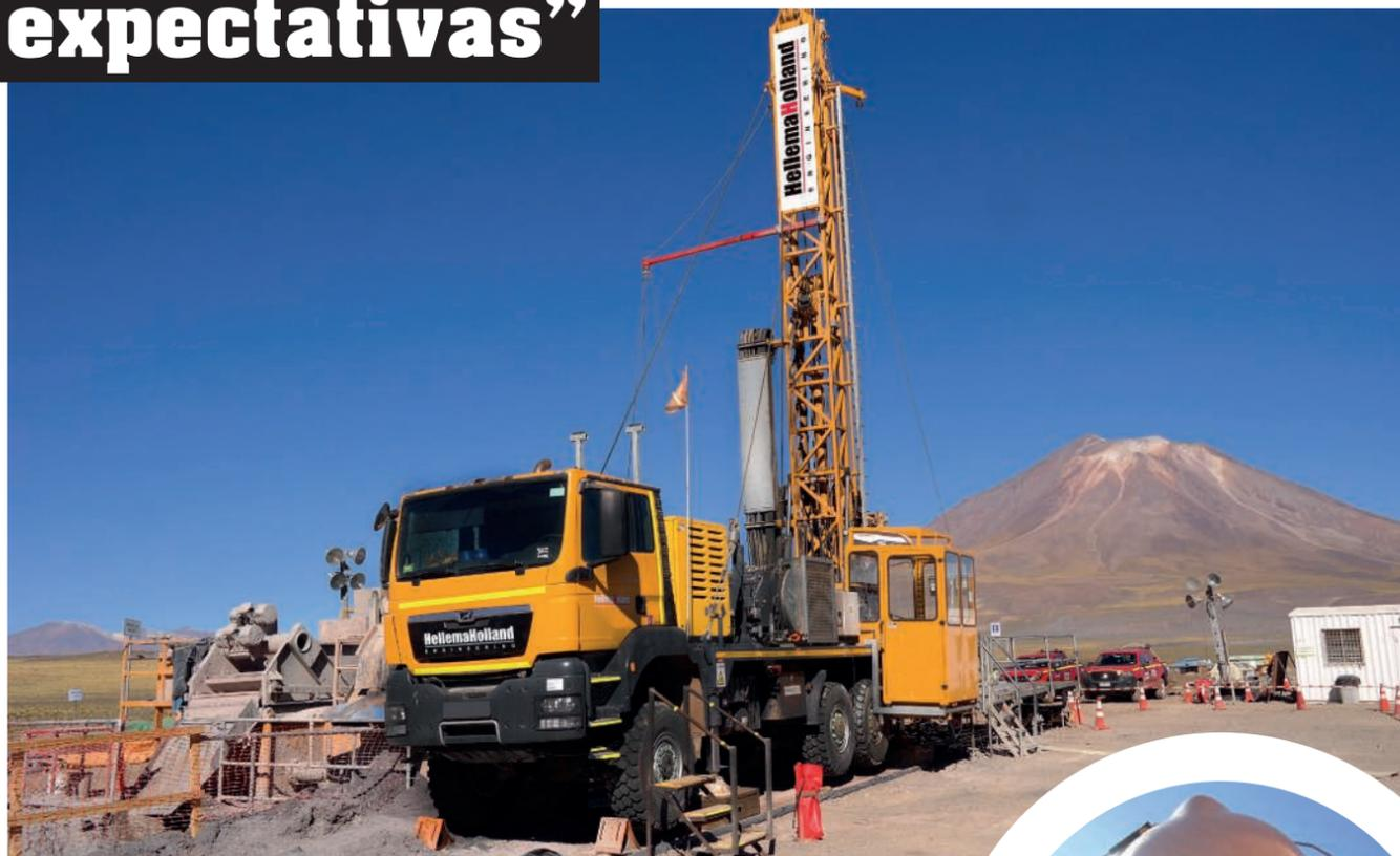
Máquina para perforación sónica y de diamantina de Hellema Holland.
